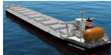
LNG fueled Cape size Bulker
